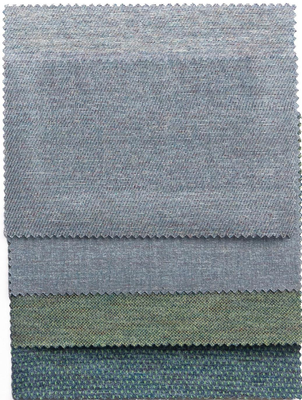
In sintesi il filato **SPLASH BLEU** è la versione 4.0 dei filati ad aspetto grigio mélange, per meglio dire: un effetto di micro stampa puntinata polverizzata, ottenuto con una combinazione di 5 colori primari, genera una risultante tonalità grigia dalla sfumatura policroma. Questo tipo di stampa produce una vibrante neutralità pronta a combinarsi con qualsiasi colore si decida di accostargli.
